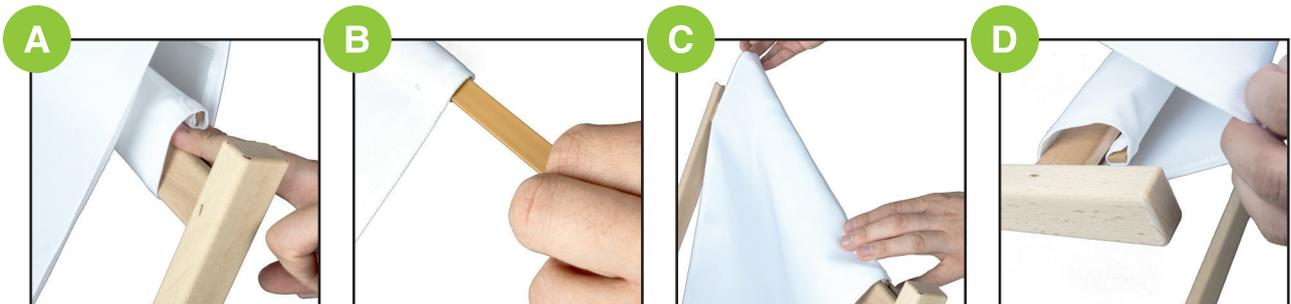
**A** Entfernen Sie die Stäbchen aus der oberen und unteren Nut.
